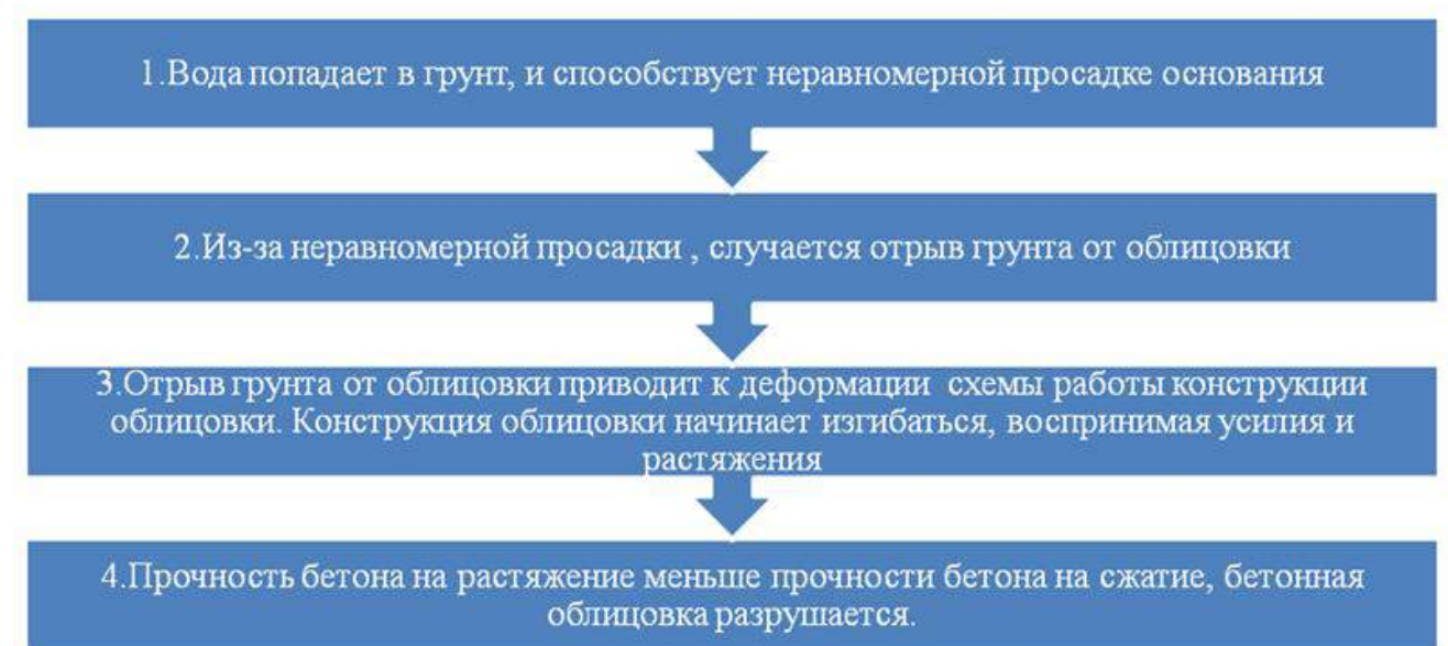
Рис.1. Механизм разрушения бетонной облицовки
