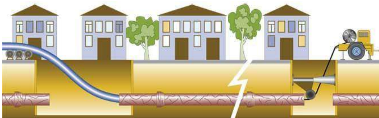
Рисунок 2. Технология восстановления трубопровода «без разрушения»
