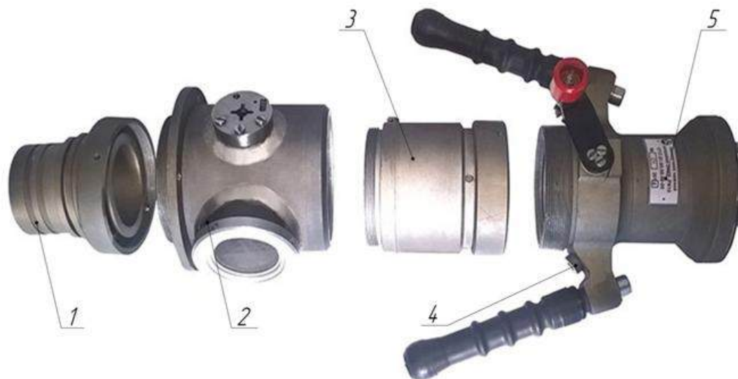
Рисунок 1 – Наконечник нижней заправки: 1 – штуцер под гибкий рукав; 2 – кран шаровой с фильтром; 3 – регулятор давления; 4 – пробоотборник; 5 – наконечник.
