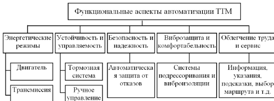
Рис. 1. Иерархическое дерево видов автоматизации ТТМ как технического объекта
