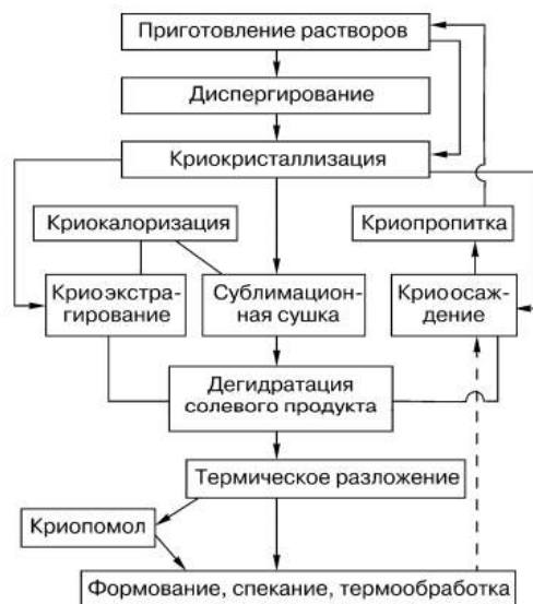
Рис. 1. Схема процессов криохимического метода синтеза.
