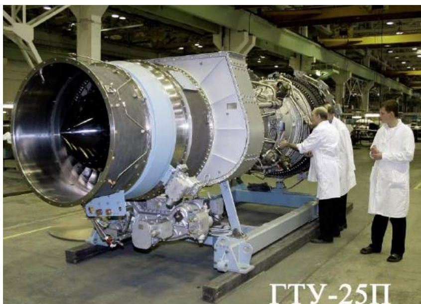
Рисунок 2. Газотурбинная установка (ГТУ)
