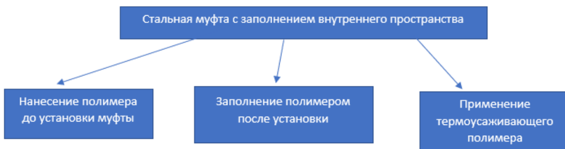
Рис. 4. Типы муфт с заполнением
